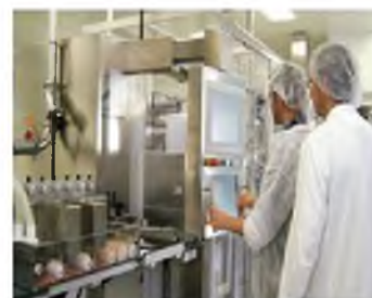
Производственная линия по упаковке твердых лекарственных средств в блистеры
