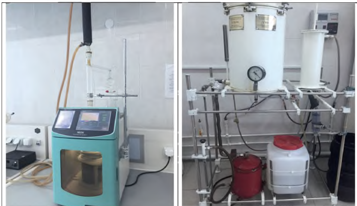
Рисунок 5. Установки для выделения эфирных масел (под действием микроволнового излучения и с водяным паром), находящиеся в лаборатории химии терпеноидов холдинга «Фитохимия»
