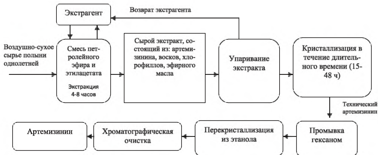
Рисунок 3. Принципиальная блок-схема производства артемизинина с использованием углеводородных экстрагентов
