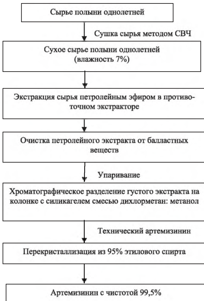
Рисунок 2. Основные этапы технологической схемы производства артемизинина компаниями Guangxi Xiancaotang Pharmaceutical CO LTD и Qingdao Zhongren Zhiye Biotechnology CO LTD
