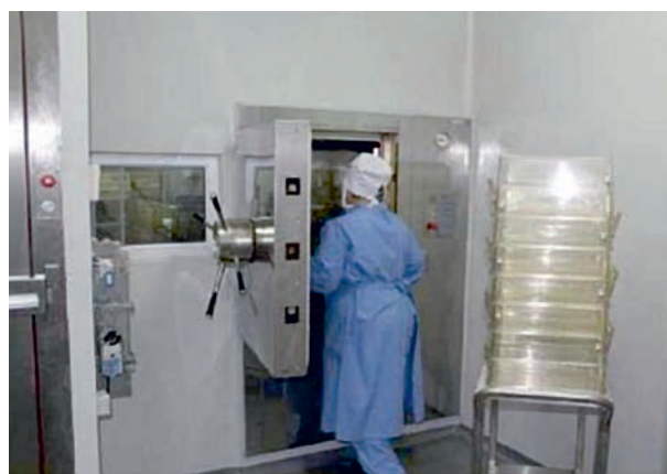
Рисунок 4 – Проходной автоклав для стерилизации клеток, поилок, кормушек и другого инвентаря под струей острого пара
